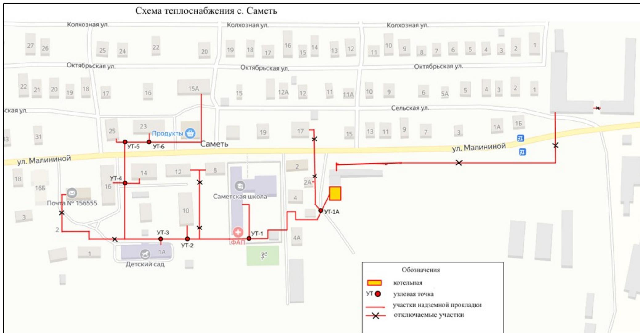
Рисунок 1.3.5. Схема теплоснабжения с. Саметь
